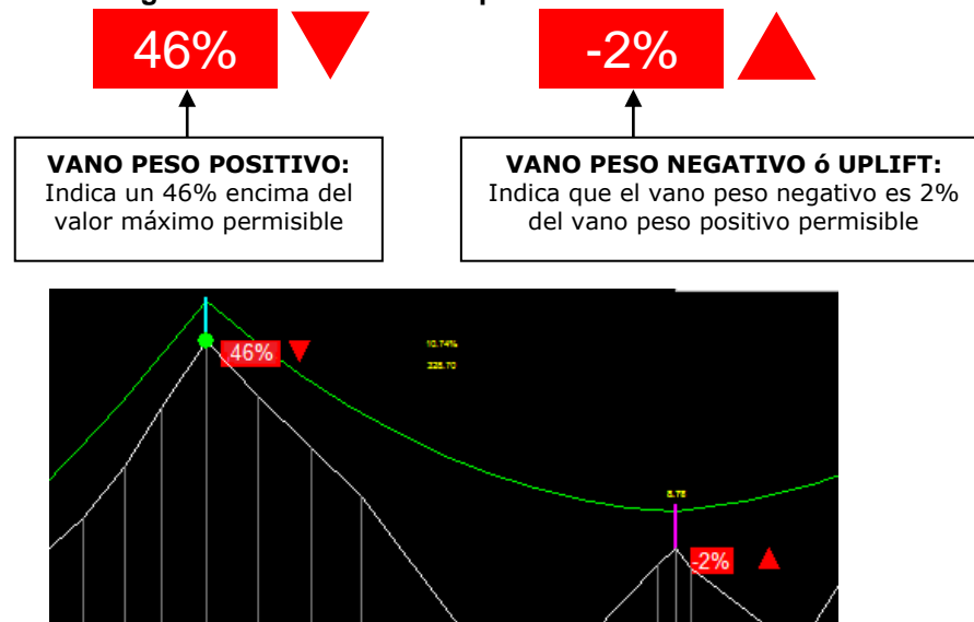
Figura 39 - Alerta de vano peso en la estructura
